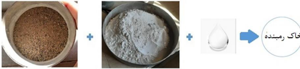
شکل ۸- نحوه ساخت خاک رمبنده در آزمایشگاه
