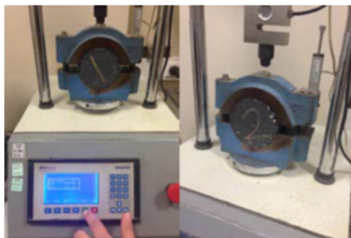
شکل ۳- آزمایش استحکام مارشال نمونه‌های حاوی ۱ درصد سیمان و ۰/۳ درصد الیاف
