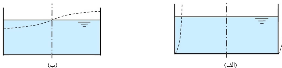
شکل ۲- شکل مودهای ارتعاشی مخزن تحت اثر زلزله، (الف) مود ضربانی و (ب) مود نوسانی [۱۳]
